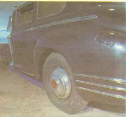
Специальный задний мост, специфическая форма «пузатых» колесных колпаков, 17-дюймовые шины свидетельствуют, что перед вами ЗИС-115.
