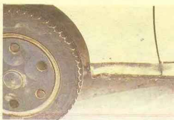
Слишком мал зазор между передним колесом и его нишей: в этом месте всегда образуются комья грязи или льда, препятствующие вращению колеса.
